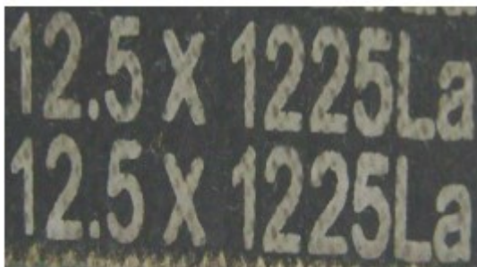
รูปภาพที่ 2.24 โค้ดสัญลักษณ์สายพานวีมาตรฐาน ISO (ที่มา: ดำรง สัพโส, 2559)
