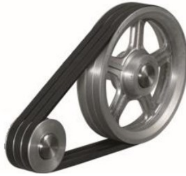
รูปภาพที่ 2.15 การส่งถ่ายกำลังด้วยสายพานวี (ที่มา: ดำรง สัพโส, 2559)
