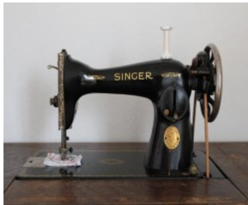
รูปภาพที่ 2.14 การใช้งานของสายพานกลม (ที่มา: ดำรง สัพโส, 2559)
