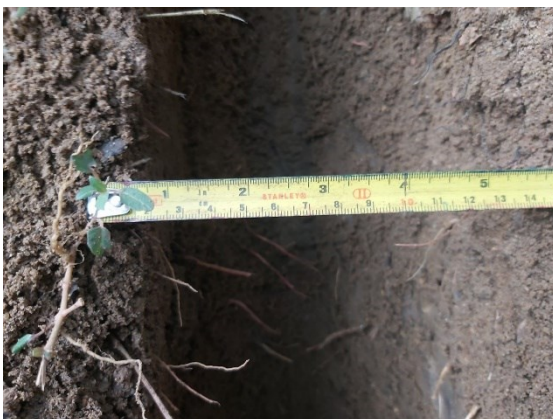
รูปภาพที่ ข.1 การทดสอบโดยใช้เครื่องขุดร่องวางท่อเกษตร
