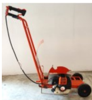
รูปภาพที่ 2.33 เครื่องขุดดินวางท่อเพื่อการเกษตร (ที่มา: วิทยาลัยการอาชีพบางสะพาน, 2563)
