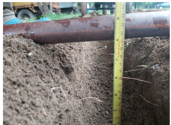
รูปภาพที่ ข.1 การทดสอบโดยใช้เครื่องขุดร่องวางท่อเกษตร
