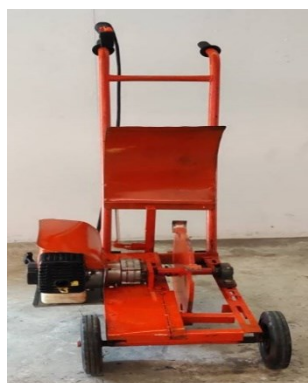
รูปภาพที่ 2.33 เครื่องขุดดินวางท่อเพื่อการเกษตร (ที่มา: วิทยาลัยการอาชีพบางสะพาน, 2563)
